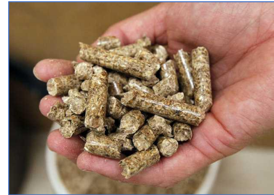
4. 木材 2 ton → ペレット 1 ton (カロリー約4600 kCal/kg)
